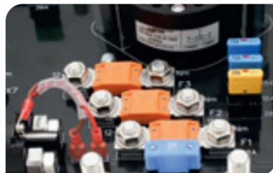
Zwei Powerelemente Stift M8 im definierten Abstand um eine Mega-Fuse Sicherung mechanisch und elektrisch mit der Leiterplatte zu verbinden.
