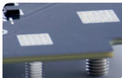
Eingepresstes Powerelement Stift M10 mit Ansicht auf die eingepressten Pins.
