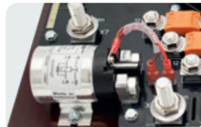
Zwei gewinkelte Powerelemente im definierten Abstand um ein Hochstromrelais mechanisch und elektrisch mit der Leiterplatte zu verbinden.
