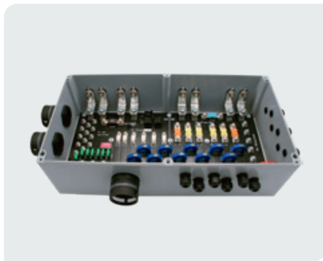
Zentralelektrik Black Box H2-Fahrzeug
