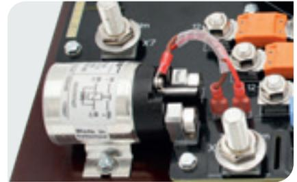
Zwei gewinkelte Powerelemente im definierten Abstand um ein Hochstromrelais mechanisch und elektrisch mit der Leiterplatte zu verbinden.
