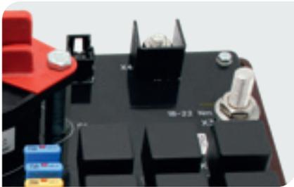
Berührschutz um das Powerelement um einen Kurzschluss durch die Berührung der Kabelschuhe zu vermeiden, die an die nebeneinander positionierten Powerelemente angeschlossen werden.
